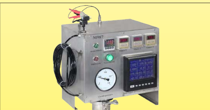
Apparecchiatura di test per misurare ripetutamente e costantemente la lunghezza massima dei tubi di collegamento degli interruttori pneumatici in funzione del volume del pulsante e della pressione che sviluppa (Laboratorio Ultimheat)
